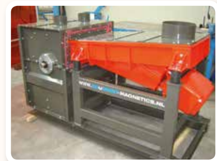
Bubnový separátor zcela zakrytý v prachotěsné skříni s magnetickým polem 6 000 gauss vhodný pro keramický průmysl
