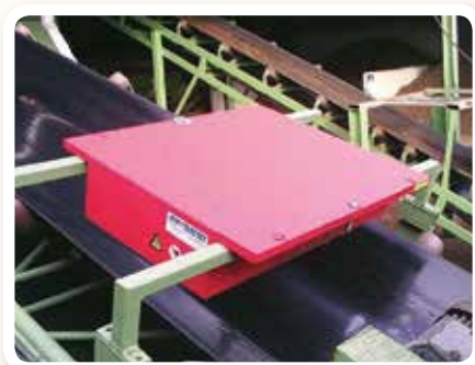
Feritový deskový magnet umístěný nad pásem pro odstraňování Fe částic z půdních substrátů
