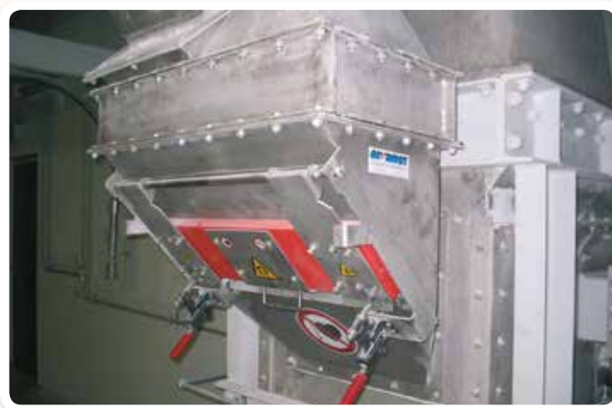
Deskový magnet umístěný ve skluzu na přívodu síla v cukrovaru
