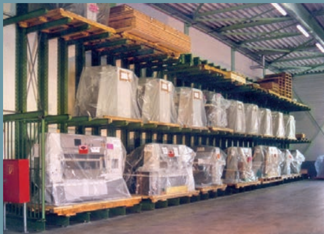
Výrobky připravené k expedici jsou až do naložení uskladněny s úsporou místa v konzolových regálech na výstupu zboží.
