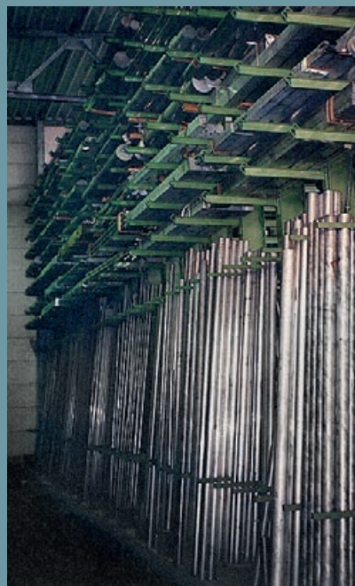
Vertikální skladování trubek a tyčového materiálu přímo na pracovišti, rozříděné a rychle vyhledatelné.
