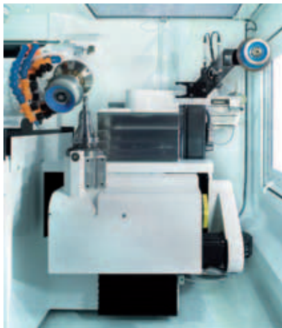
Vertikální uspořádání a přímý náhon vřetene zaručují nejvyšší přesnost na obrobku.
