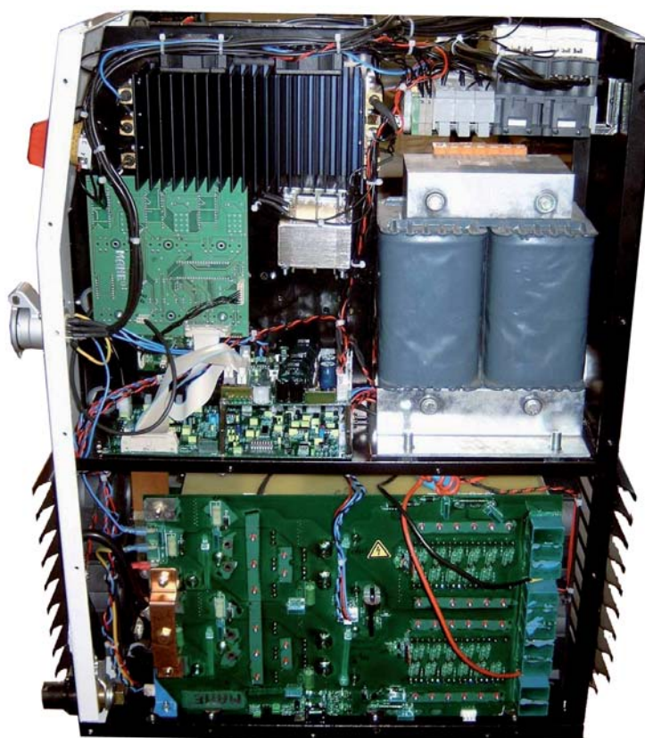
Obr. 8: Konštrukcia inverterového zväracieho zdroja MAHE GAMA 1260
