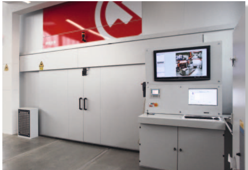
Die Steuer- und Bedieninstrumente der Anlage sind im zentralen Steuerpult übersichtlich zusammengefasst.
