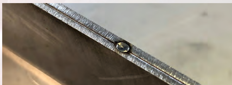
Bodování - materiál nerez 1,5 mm
