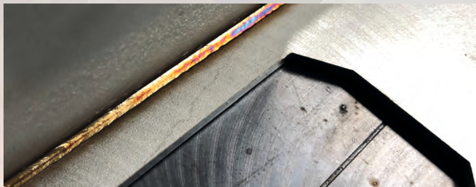
Koutový svar - materiál nerez 3 mm
