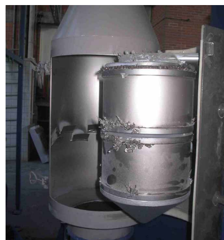
Separator stożkowy montowany do góry nogami do granulatu plastikowego
