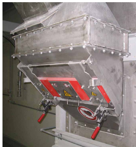
Separator montowany w zsypie w produkcji cukru przed wejściem produktu
